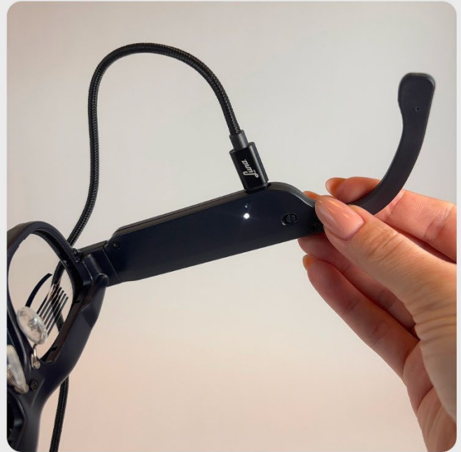
Als de LED knippert, is het apparaat aan het opladen
