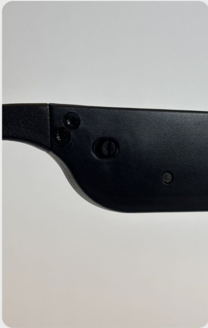
L'interruttore è posizionato su "off"
