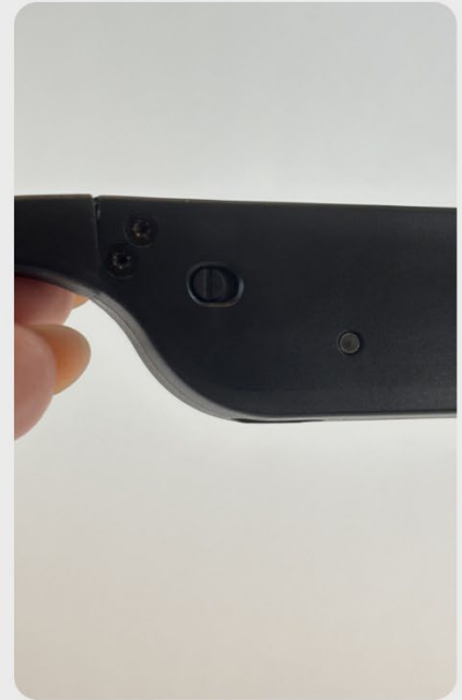
L'interruttore è posizionato su "on"
