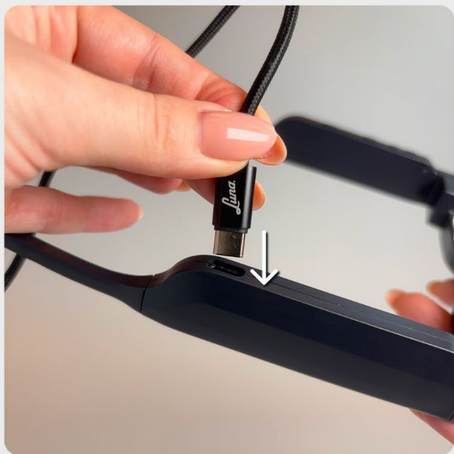
Insertion du câble USB-C
