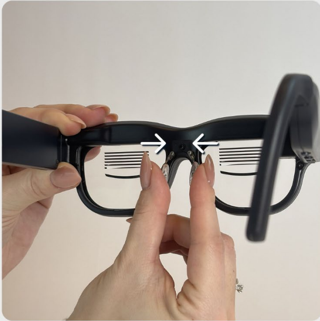
Rapprocher les plaquettes de nez en exerçant une légère pression
