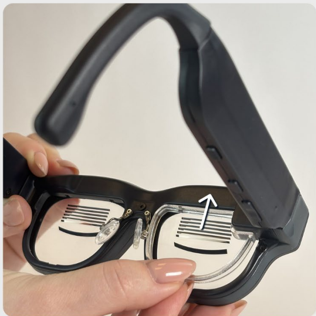
Positionnement du support de verre dans la monture
