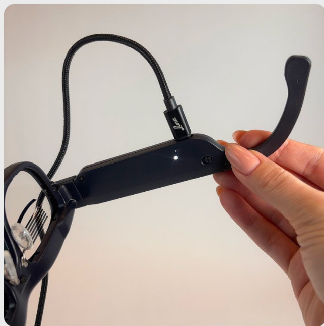
La LED clignote, indiquant que l'appareil est en cours de chargement
